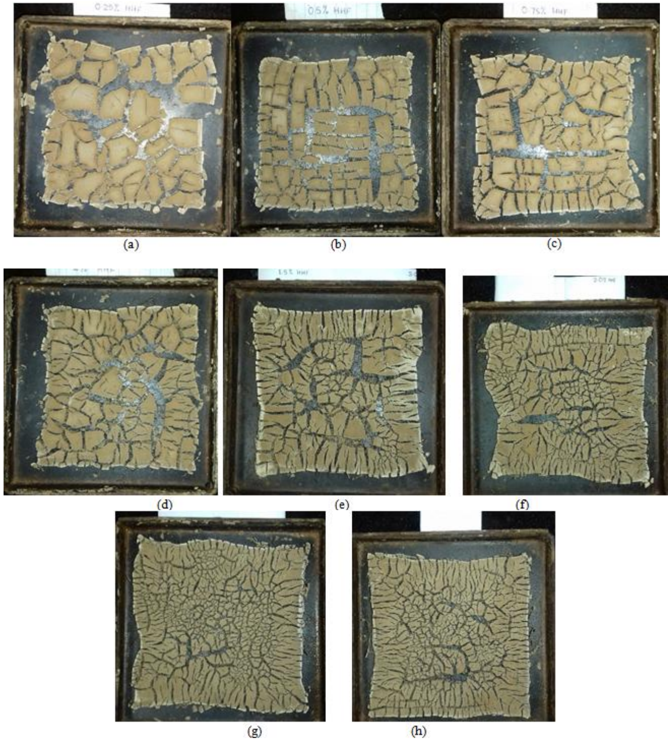
Figure 11: Desiccation Cracking patterns at (a) 0.25 % HHF (b) 0.50 % HHF (c) 0.75 % HHF (d) 1.00 % HHF (e) 1.50 % HHF (f) 2.00 % HHF (g) 2.50 % HHF (h) 3.00 % HHF
