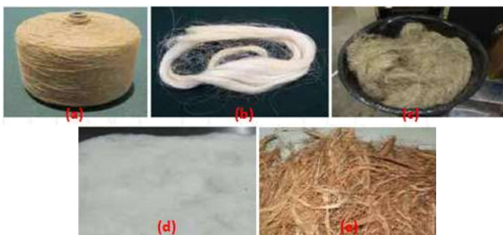
Figure 1.7.1: (a) Jute yarn (b) Sisal fibre (c) Hemp fibre (d) Cotton fibre (e) Coir fibre
