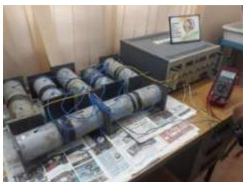
**Figure 5:** Chloride diffusion Test
