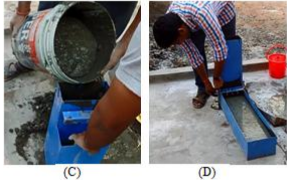
Figure 2: (C) U-Box Test (D) L-Box Test
