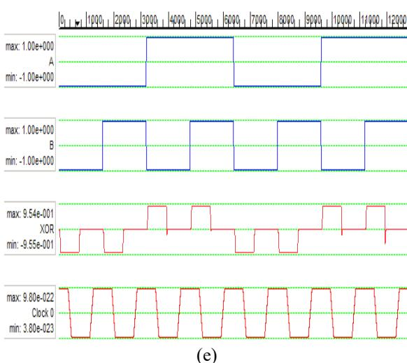
**Figure 7:** (d) QCA layout Multilayer XOR (e)Simulation results
