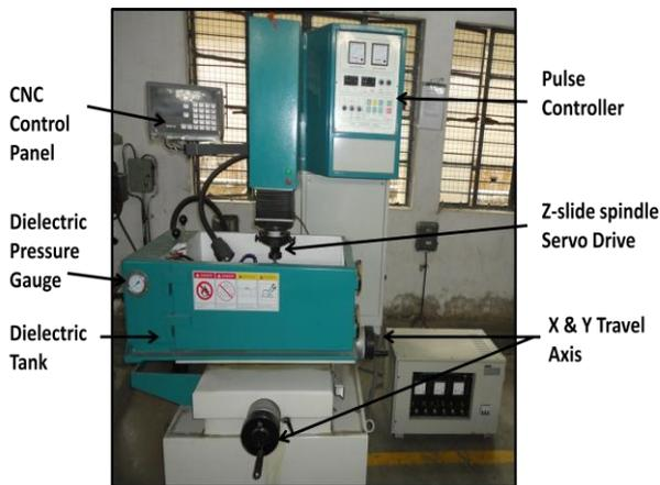
**Figure 2:** Experimental die sink EDM
